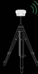
送受信の統合データリンクを内蔵したフル機能のRTKです。モバイルステーションと基地局をワンクリックで簡単に切り替えることができ、最大動作距離は15kmです。主要な業界標準プロトコルと互換性があります。
