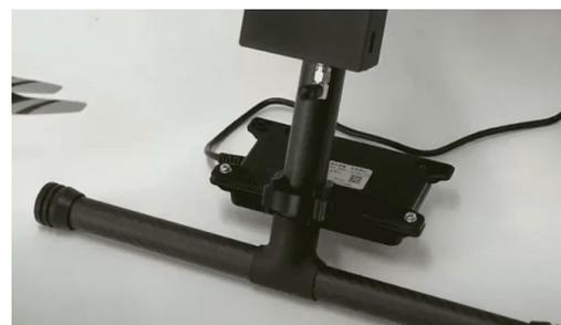
Obstacle Detection Radar（障害物検知レーダ）
