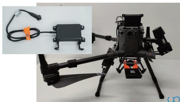
Nano Radar NA24（レーダ高度計）
